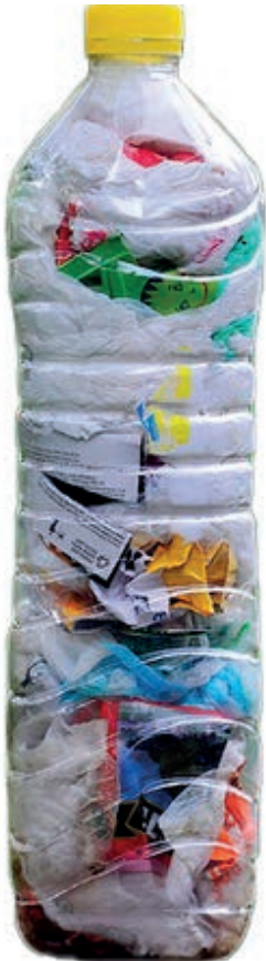
Realizada con ecoladrillos (botellas de pet rellenas de plástico compactado)
